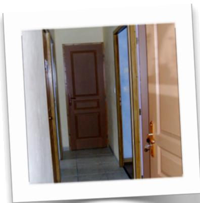
Largeur d'un couloir : 1,20 m à 1,40 m (norme pour handicapé en fauteuil roulant).
