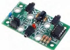
Le boîtier de commande ou automate « **AutoProg** » est système modulaire programmable fonctionnant avec la technologie Picaxe. Il est constitué d'un boîtier de commande programmable que l'on relie par des cordons type jack à des modules capteurs et actionneurs.
